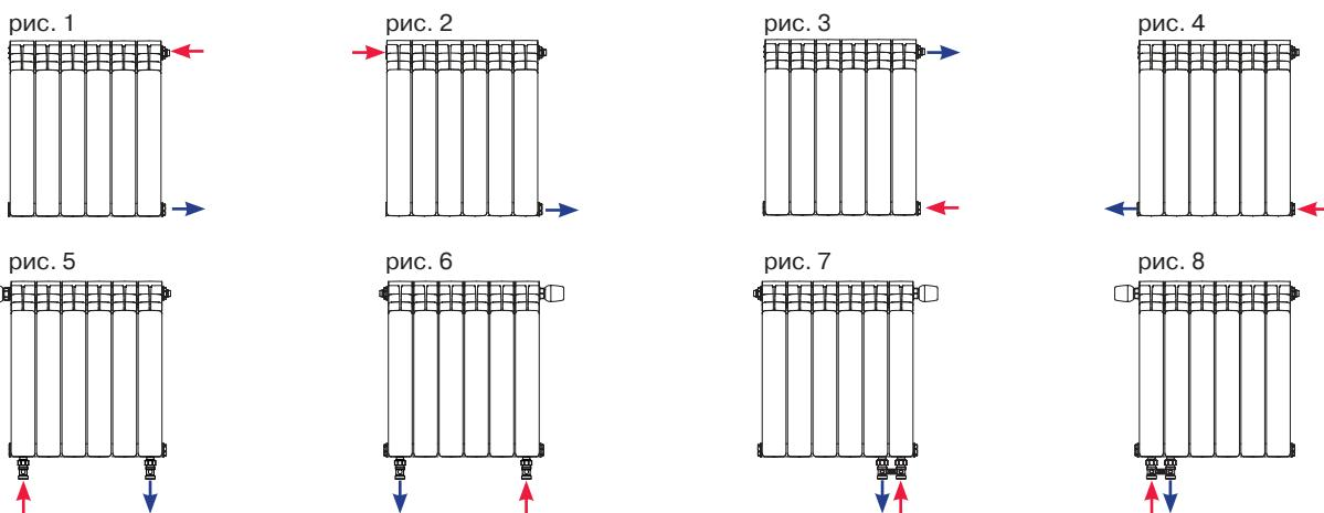
Наиболее предпочтительными схемами подключения, с точки зрения эффективной теплоотдачи, являются: рис. 1; рис. 2. При подключении радиатора по схеме рис. 3 его тепловая мощность может быть значительно сниже-
